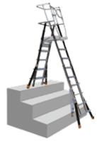
THE ROCK LOCKS ADJUST THE HEIGHT OF THE CAGE. PUSH IN ON THE BOTTOM OF THE ROCK LOCK TO OPEN, TAP THE ROCK LOCK TO CLOSE. UNLOCK ONLY ONE ROCK LOCK AT A TIME WHILE SUPPORTING THE INNER LADDER ASSEMBLY WITH ONE HAND. DO NOT UNLOCK THE ROCK LOCK IF ANYONE IS ON THE CAGE.
