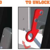
LOWER THE CAGE HEIGHT TO THE SHORTEST POSITION, PULL THE LOCKS OUT AND UP TO RELEASE THE PLATFORM
